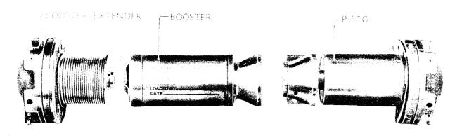
FUZE, BOMB, HYDROSTATIC, TRANSVERSE, AN-Mk. 224
