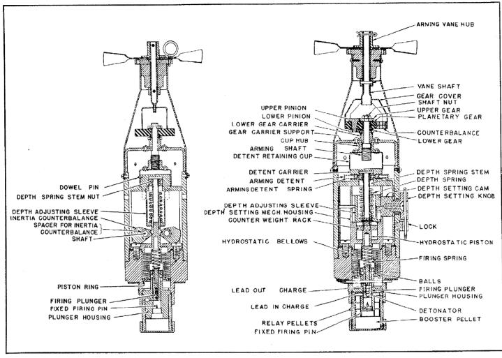
FUZE, BOMB, HYDROSTATIC, AN-Mk. 230-UNARMED POSITION
