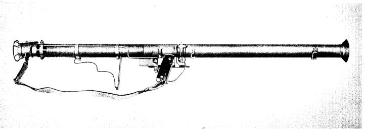
2.36 INCH ROCKET LAUNCHER, M9A1-RIGHT SIDE VIEW
