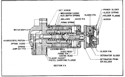
FUZE, BOMB, HYDROSTATIC, TRANSVERSE, AN-Mk. 224-PISTOL
