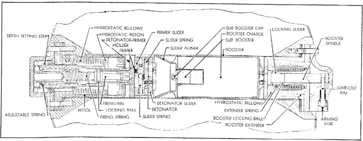
FUZE, BOMB, HYDROSTATIC, TRANSVERSE, AN-Mk. 234
