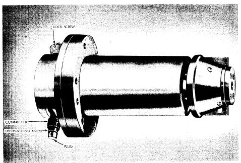
FUZE, BOMB, HYDROSTATIC, TRANSVERSE, AN-Mk. 234-PISTOL
